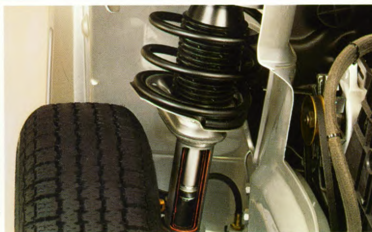
Voorwielophanging met veerpoten volgens het McPherson-principe.
