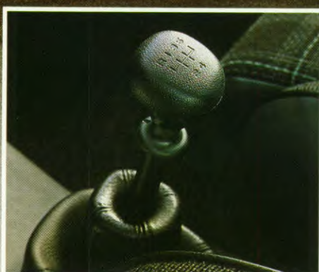
Nóg economischer schakelen: met een 5-versnellingsbak daalt het verbruik, toerental en slijtage. Standaard bij de 1.8 E-OHC-motor.
