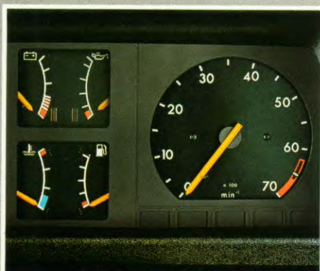
Mooi sportief: toerenteller, oliedruk- en voltmeter geven exacte informatie over de motor. (Niet leverbaar bij de 1.6 D-motor.)
