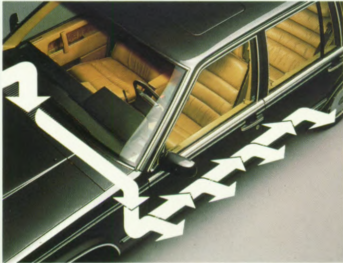
Een Volvo specialiteit... geventileerde dorpels voorkomen roest van binnenuit.
