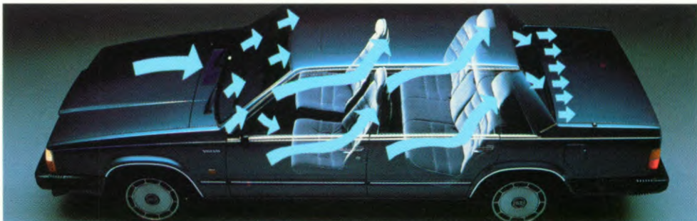
13 uitstroomopeningen en ventilatioeroosters
