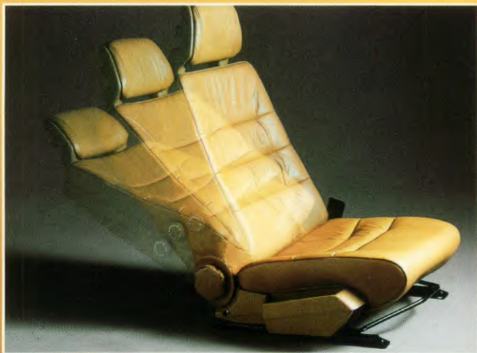
De wereldvermaarde Volvo stoel is samen met de medische wereld ontwikkeld, om een voortreffelijke ondersteuning en een maximum aan comfort te bieden. De voorstoelen zijn elektrisch verwarmd. Er is een driestanden-schakelaar voor elke stoel.
