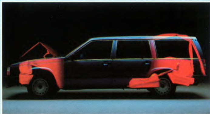
Kreukelzones voor en achter absorberen de zware krachten bij aanrijdingen, om de passagiers te beschermen. De brandstoftank is veilig opgeborgen.
