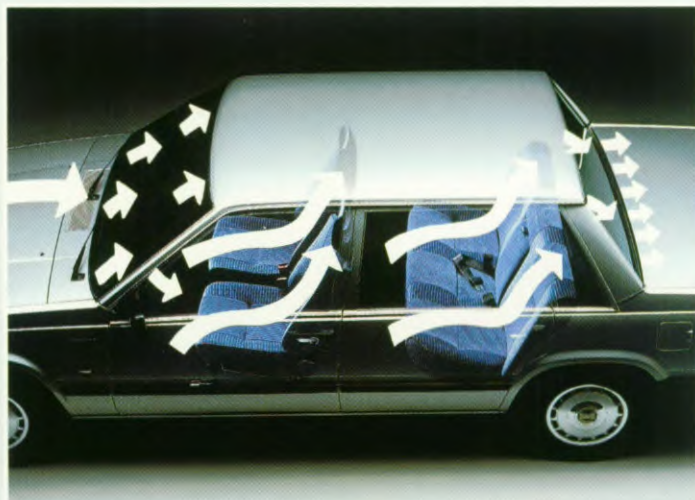
Niet minder dan 13 uitstroomopeningen voorzien in een supersnelle en efficiënte klimaatcontrole in uw Volvo. Aanpassingen gebeuren precies en direct.
