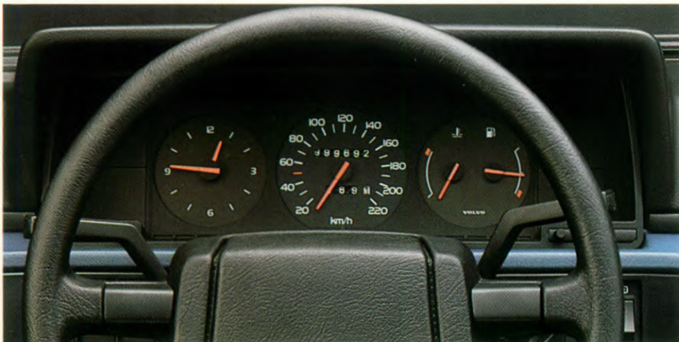
Ergonomisch ontworpen dashboard met instrumenten die in één oogopslag zijn af te lezen (Volvo 740 GL).
