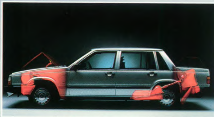
Kreukelzones voor en achter absorberen de zware krachten bij aanrijdingen, om de passagiers te beschermen. De brandstoftank is veilig opgeborgen voor de achteras.
