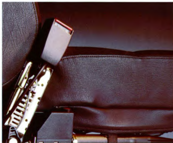
De automatische gordelaanspanner zorgt er voor dat de driepuntsveiligheidsgordel bij een aanrijding strak wordt aangespannen, waardoor het lichaam zo effectief en zo veilig mogelijk op zijn plaats wordt gehouden.
