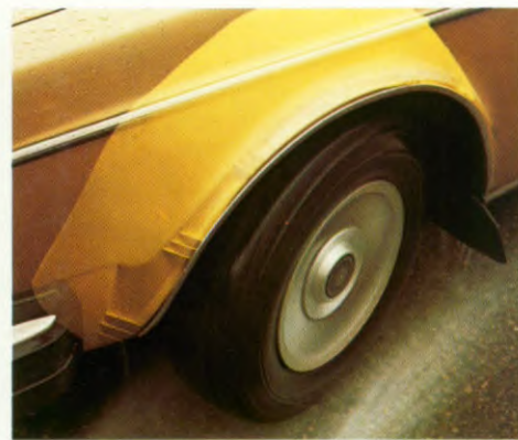
De wielkuipten van de voorwielen hebben een extra binnenscherm van kunststof. Dit beschermt het metaal tegen vocht en steenslag.
