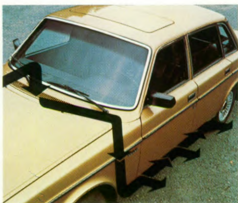
De rijwind zorgt voor verdamping van het in de dorpels aanwezige vocht en voorkomt zodoende corrosie.
