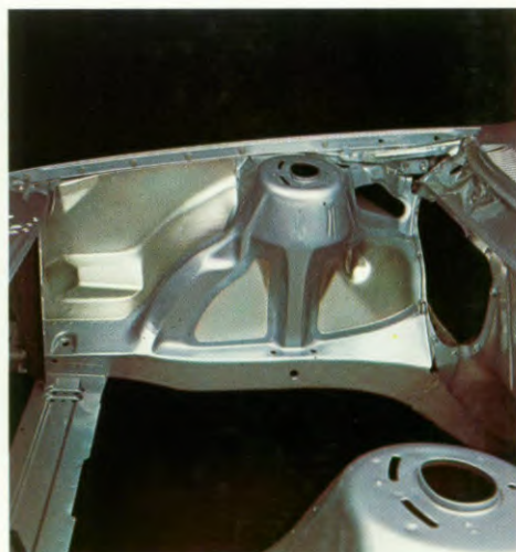
Er wordt veel gebruik gemaakt van zeer corrosiebestendig dubbelzijdig gegalvaniseerd plaatstaal (zinklaag dikte: 3 tot 4 keer dikker dan die bij de meeste andere merken).
