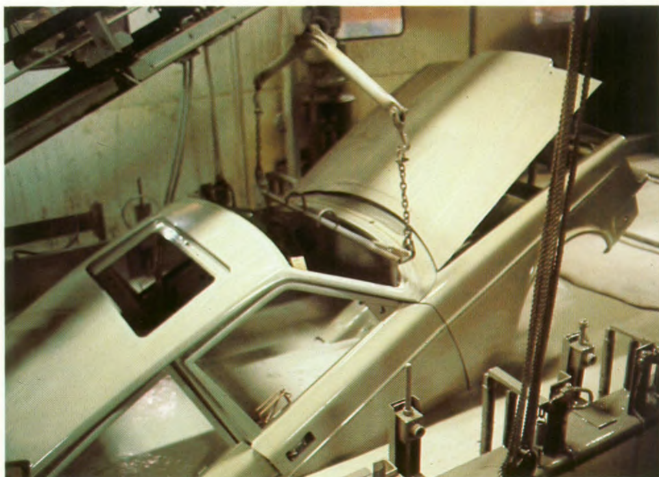
De eerste stap van een uitgebreide carrosseriebehandeling: Onderdompeling in een elektrisch geladen lakbad. Ook op 'onbereikbare' plaatsen wordt zo lak aangebracht.
