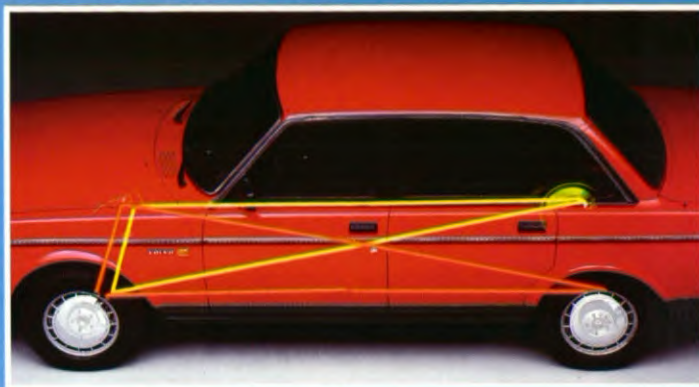
Triangel gescheiden remsysteem. Zelfs als één remcircuit zou uitvallen, houdt u nog 80% remvermogen over.
