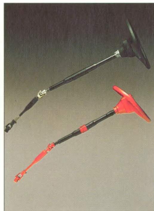
Samendrukbare stuurkolom met veiligheidsstuur.
