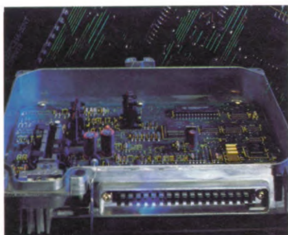
De kern van het elektronisch motormanagementsysteem wordt gevormd door een microprocessor, die zowel het ontstekingsmoment als de brandstofinjectie reguleert.
