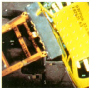
De verstevigde portieren en de sterke stalen dwarsbalken verminderen de kans op ernstig letsel bij een zijdelingse aanrijding aanzienlijk dankzij het Side Protection System (SPS).
