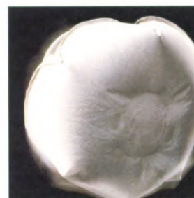
De airbag bevindt zich in het stuurwiel. Bij een ernstige frontale aanrijding wordt de airbag in een oogwenk met lucht opgeblazen.
