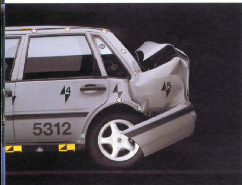
opgevangen door de kreukelzones voor en achter; hierdoor zijn de krachten moet opvangen minder groot.
