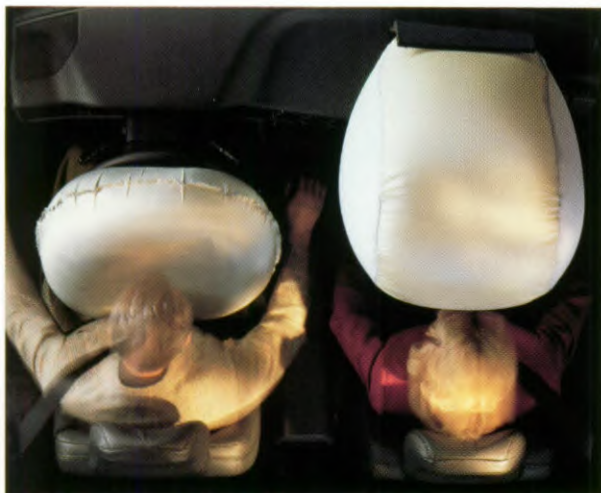
Voor de bestuurder en de voorpassagier is, als doeltreffende aanvulling op de veiligheidsgordel, een airbag leverbaar ter bescherming van borst, hoofd en nek.
