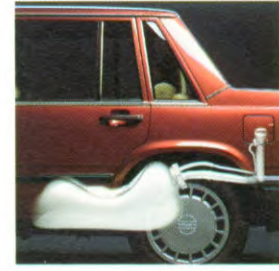
1974 Geïsoleerde vervorm- bare brandstoftank
