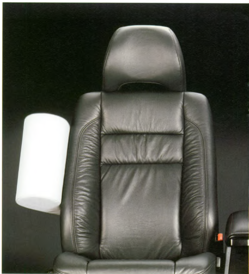
De SIPS-bags bij de Volvo 850 zijn in de rugleuning geplaatst zodat ze,
