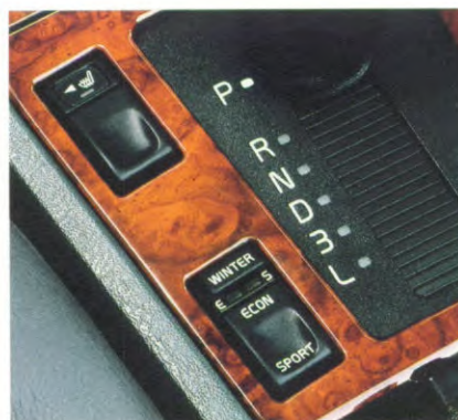
Het Economy-programma is brandstofbesparend, het Sport-programma laat de motor op tophoogte presteren, en het Winter-programma zorgt voor probleemloos wegrijden op gladde wegen.
