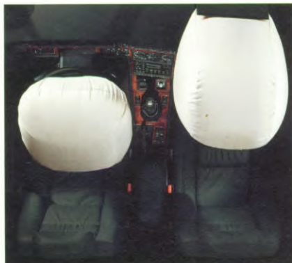
De 65-liter airbag van de bestuurder is in het stuurwiel geplaatst. De passagiersstoel voor kan desgewenst ook worden voorzien van een airbag met een inhoud van 135 liter. Bij een ernstige frontale botsing worden de airbags in een fractie van een seconde met lucht gevuld.
