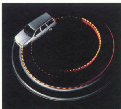
De draaicirkel is slechts 10,2 meter kleiner dus dan bij andere auto's met voorwielaandrijving uit deze categorie.
