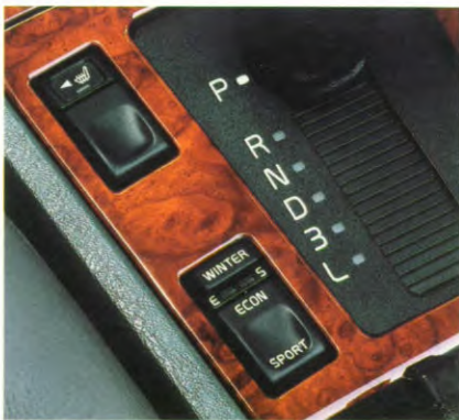
Het Economy-programma is brandstofbesparend, het Sport-programma laat de motor op topniveau presteren, en het Winter-programma zorgt voor probleemloos wegrijden op gladde wegen.
