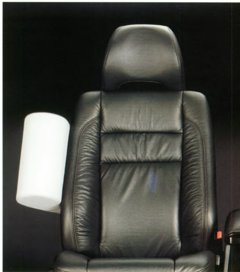
De SIPS-bags bij de Volvo 850 zijn in de rugleuning geplaatst zodat ze...
