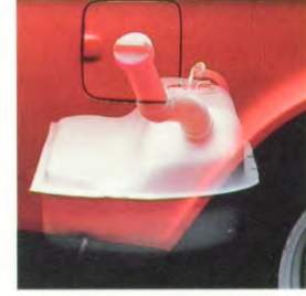
1974 Geïsoleerde vervorm- bare brandstoftank
