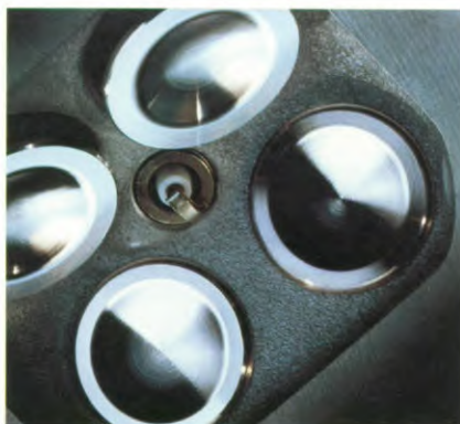
Met vier kleppen per cilinder krijgt de motor meer lucht, zelfs bij een hoog motortoerental. Het resultaat is een hogere trekkracht en topsnelheid.
