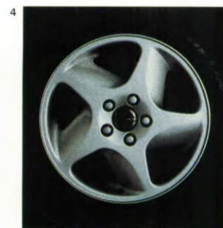
COLUMBA 6,5x16" (linkerzijde) voor 850 vanaf modeljaar 1994 Bandenmaat 205/50R16
