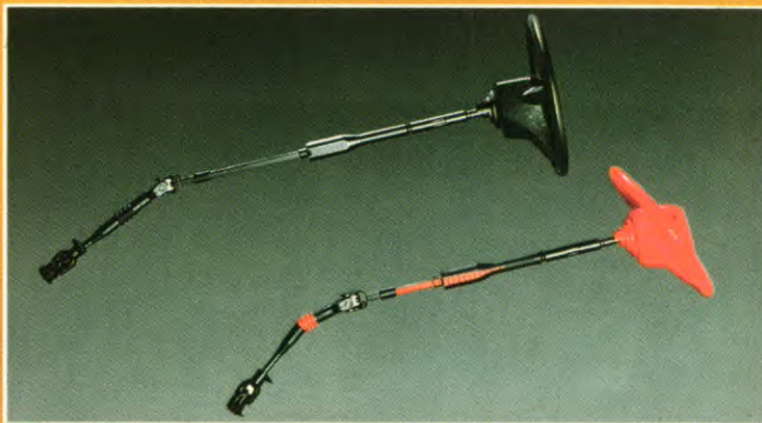
Samendrukbare stuurkolom met veiligheidsstuurwiel.
