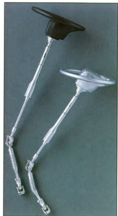
De samendrukbare stuurkolom voorkomt ernstig letsel bij frontale aanrijdingen.
