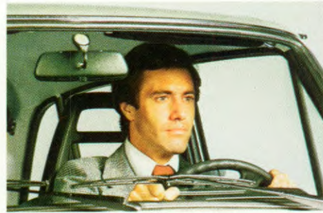
De voorruit is van gelaagd "high impact" glas, (breekt niet, blijft doorzichtig en bovendien winddicht).
