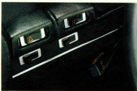
Op het dashboard tuimelschakelaars voor verlichting, achterrautverwarming, waarschuwingsknipperlichten en lagere versnelling.
