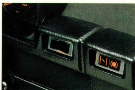
Rechts van het stuur op het dashboard waarschuwingslampjes voor remvloeistof-niveau, handrem en choke.
