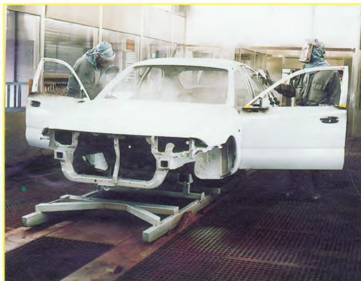
In de spuitcabine van de Lakstraat brengen de spuiters handmatig een laklaag aan op de deuropening van de body. De complete body wordt vervolgens door de spuitrobot afgewerkt in de uiteindelijke kleur die de koper uit het kleurenscale van de Carisma heeft uitgezocht.
