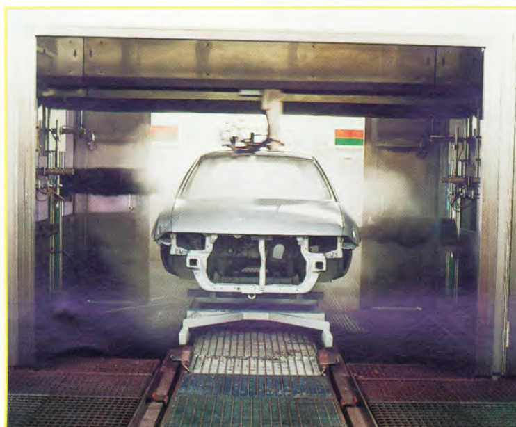
In de spuitcabine van de Lakstraat brengen de spuiters handmatig een laklaag aan op de deuropening van de body. De complete body wordt vervolgens door de spuitrobot afgewerkt in de uiteindelijke kleur die de koper uit het kleurenscale van de Carisma heeft uitgezocht.
