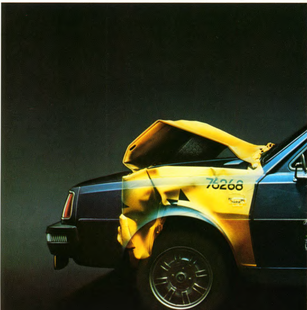
De dummies worden in de auto's geplaatst en zijn verbonden met apparatuur die zeer nauwkeurig registreert welke reacties de botsing teweegbrengt.
