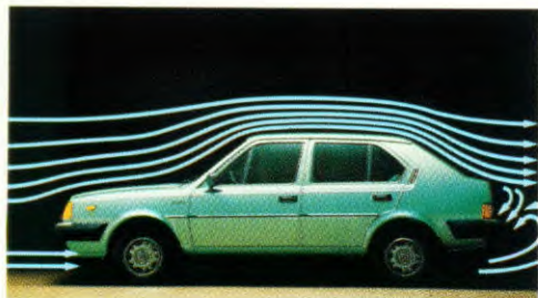
De aerodynamische vorm werd na uitgebreide windtunneltesten bepaald.
