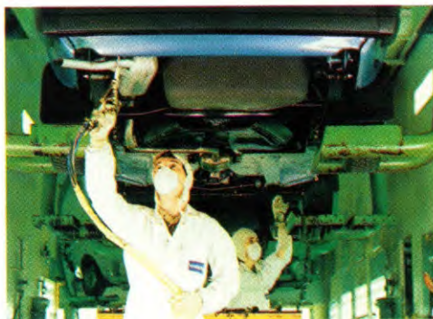
Voordat de auto de fabriek verlaat krijgt hij een anti-roest behandeling volgens de ML-methode.
