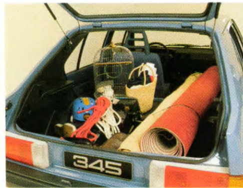
De rugleuning van de achterbank is snel verwijderd. Als het moet kan zelfs de voorstoel eruit.
