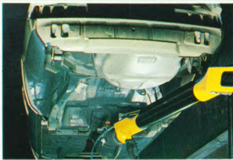
Volledige coating van de onderkant met kunststof.
