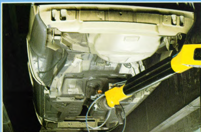
Volledige coating van de onderkant met kunststof.
