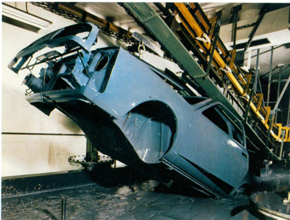
De carrosserie wordt volledig ondergedompeld in een elektrostatisch geladen lakbad. Ook op 'onbereikbare' plaatsen wordt zo lak aangebracht.
