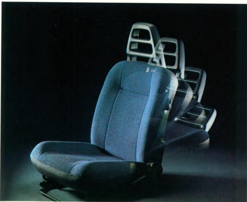
De rugleuningen van de stoelen kunnen traploos worden versteld tot bijna horizontaal. De stoel zelf is over een afstand van 25 cm te verschuiven.
