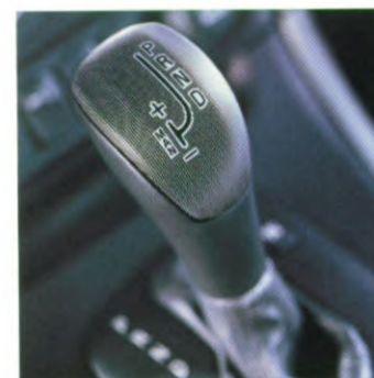
Met de viertraps Geartronic automaat kunt u ook handmatig schakelen voor een meer actieve rijstijl. U schakelt op door de pook naar voren te duwen en u schakelt terug door de versnellingspook naar u toe te bewegen (alleen leverbaar op de Volvo S80 T6).
