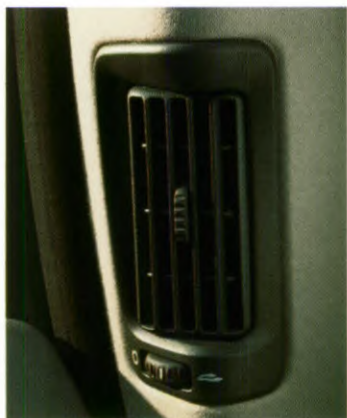
Een opening voor het ventilatie- en verwarmingssysteem in de B-stijl vergroot het comfort voor de passagiers achterin en houdt de zijruiten achterin condensvrij.
