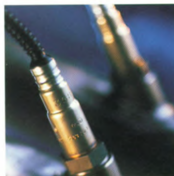
De drieweg katalysator met elektrisch verwarmde Lambda-sonde haalt meer dan 95 procent van de koolmonoxide, stikstofoxide en koolwaterstoffen uit de uitlaatgassen.
