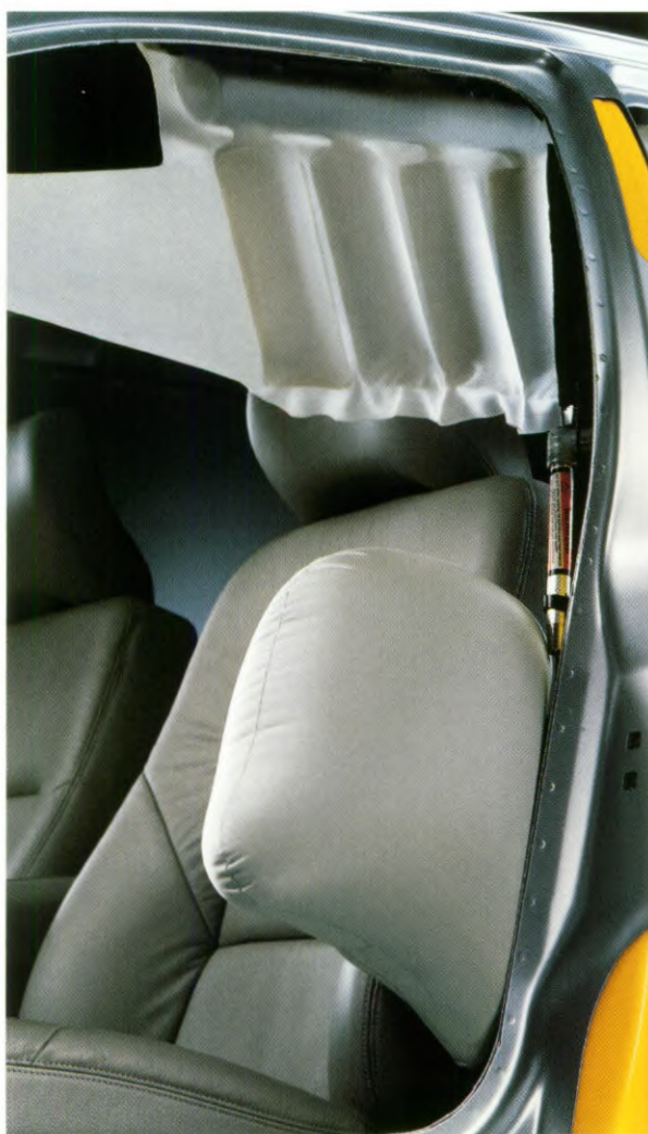
SIPS - Side Impact Protection System (voor bescherming tegen zijdelingse aanrijdingen), SIPS-bags (zij-airbags voor bescherming van de borst) en IC - Inflatable Curtains (airbags voor bescherming van het hoofd) maken van de Volvo S80 een uitzonderlijk veilige auto.
