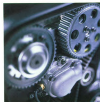
Variabele nokkenassen voor de in- en uitlaatkleppen geven de motor een constante trekkracht bij alle toerentallen - en schonere uitlaatgassen.
