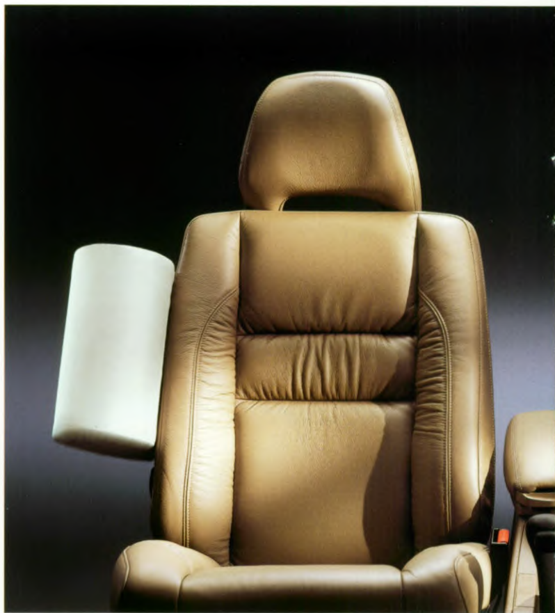
De SIPS-bags van Volvo zijn in de rugleuning geplaatst zodat ze, ongeacht de stand
