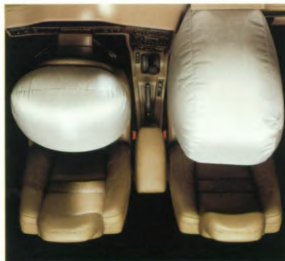
De 65-liter airbag van de bestuurder is in het stuurwiel geplaatst. De passagiersstoel voor kan desgewenst ook worden voorzien van een airbag met een inhoud van 135 liter.
