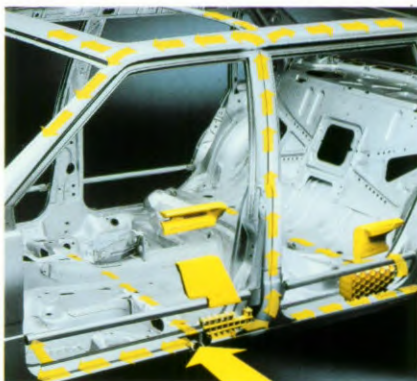
Volgens het SIPS-principe worden bij een zijdelingse botsing de krachten geabsorbeerd en verdeeld over de verschillende delen van de auto, waardoor een botsing beter kan worden opgevangen.
