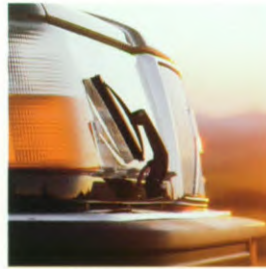
1973 Koplamp Wis/Was installatie
