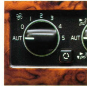
De Electronic Climate Control (ECC), handhaaft exact de door u ingestelde temperatuur, hoe warm of koud het buiten ook is. Uiteraard is dit systeem CFK-vrij.
