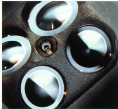
Omdat elke cilinder vier kleppen heeft, krijgt de motor extra lucht, zelfs bij een hoog motortoerental. Het resultaat is een hogere trekkracht en topsnelheid.
