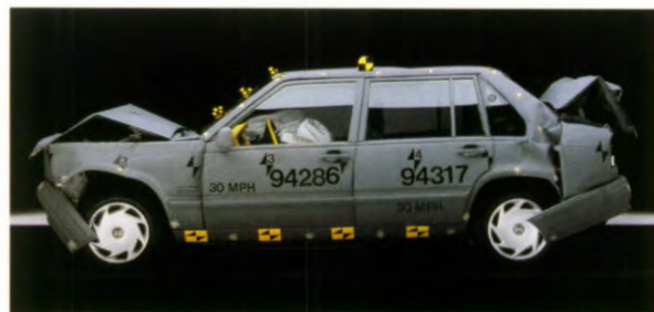
De kreukelzones aan de voor- en achterzijde vangen een groot deel van de klap op, zodat de meeste krachten al zijn opgevangen voordat ze de rest van de sterke veiligheidskooi bereiken.
