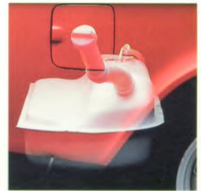
1974 Geïsoleerde vervorm- bare brandstoftank
