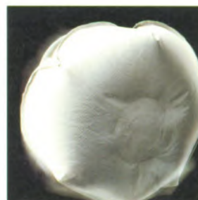
De 65-liter airbag van de bestuurder is in het stuurwiel geplaatst. De passagiersstoel voor kan desgewenst ook worden voorzien van een airbag met een inhoud van 135 liter. Bij een ernstige frontale botsing worden de airbags in een fractie van een seconde met lucht opgeblazen.
