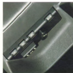
De als extra leverbare electrisch verstelbare bestuurdersstoel is moeiteloos in de juiste stand te plaatsen. U kunt als bestuurder drie verschillende standen opslaan in het geheugen, hetgeen ideaal is als verschillende bestuurders van de auto gebruik maken.
