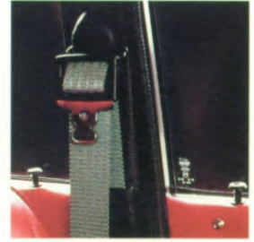
1969 Automatische rolgordels voor
