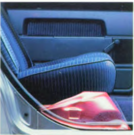
1982 Bescherming doorglijden onder veiligheidsgordels
