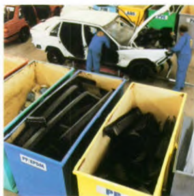
In Volvo's proeffabriek voor recycling zoekt men naar de beste methodes voor het ontmantelen, scheiden en recyclen van de diverse materialen die in auto's worden toegepast.
