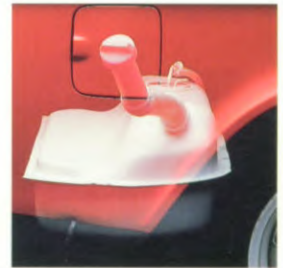
1974 Geïsoleerde vervorm- bare brandstoftank
