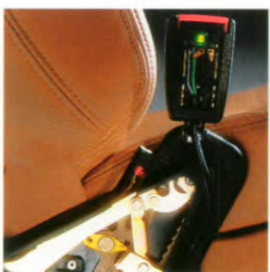
1987 Automatische gordelaanspanner voorstoelen
