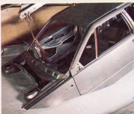
Elektro-dompelbad met primer, voor totale roestbescherming.
