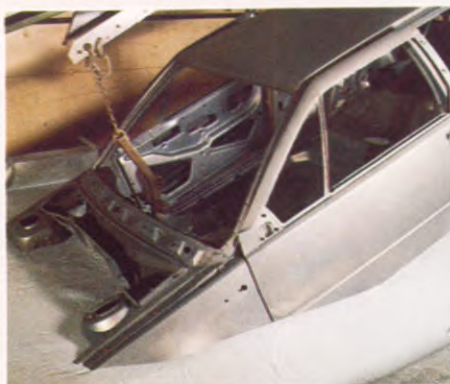
Elektro-dompelbad met primer, voor totale roestbescherming.
