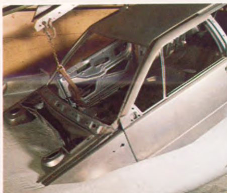
Elektro-dompelbad met primer, voor totale roestbescherming.
