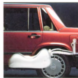
1974 Geïsoleerde vervorm- bare brandstoftank
