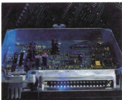
De kern van het elektronisch motormanagementsysteem wordt gevormd door een microprocessor, die zowel het ontstekingsmoment als de brandstofinjection reguleert.
