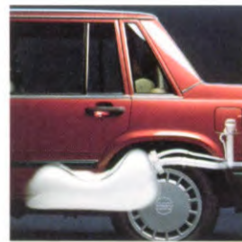
1974 Geïsoleerde vervorm- bare brandstoftank
