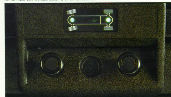
Differentieelblokkeringen bij de Syncro. Twee differentieelblokkeringen standaard.
