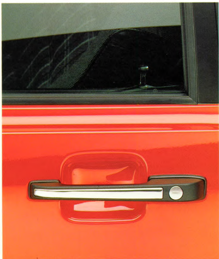
De centrale portiervergrendeling. Portieren, bagageruimte en tankdopklepje worden automatisch ver- en ontgrendeld. Het rechter portier kan apart geopend worden.
