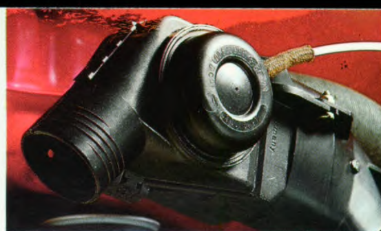
De thermostaat voor de aanzuiglucht-voorverwarming.
