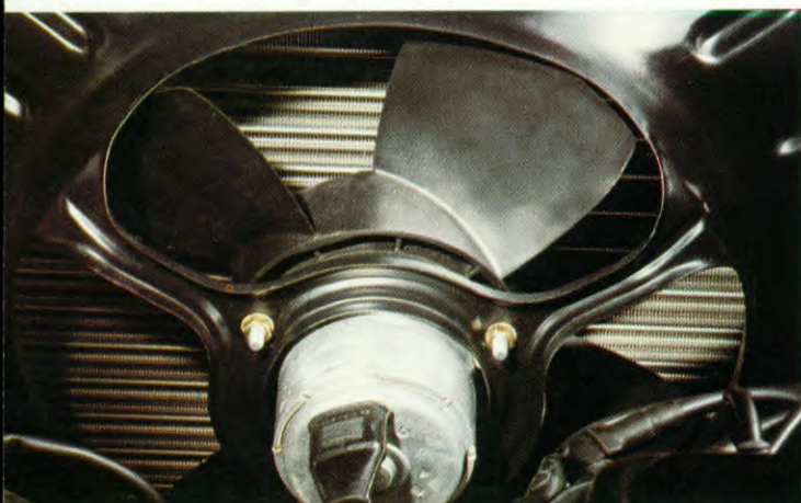
De Scirocco heeft een elektrisch aangedreven, thermostatisch geregelde koelventilator, die alleen werkt wanneer dat nodig is. Dat spaart energie.
