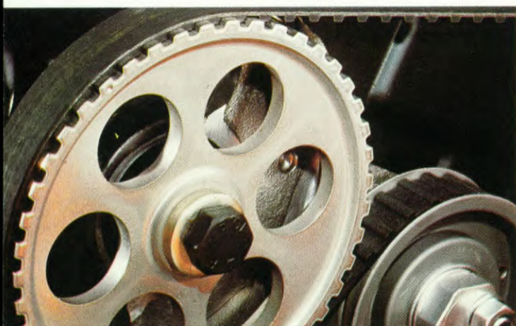
De motoren van de Scirocco behoren tot de modernste ter wereld. Neem bijvoorbeeld de aandrijving van de nokkenas. Veel merken gebruiken nog een ketting, terwijl de Scirocco al jaren een geruisarme getande riem heeft.
