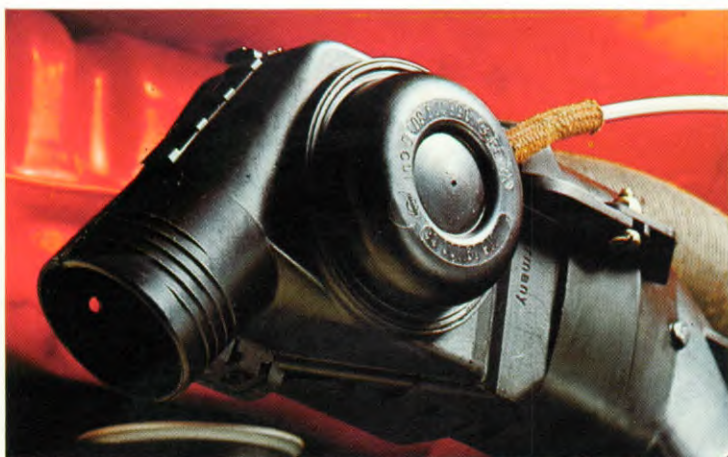
Afhankelijk van de buitentemperatuur, regelt een thermostaat in het luchtfilter de temperatuur van de aangezogen lucht.
