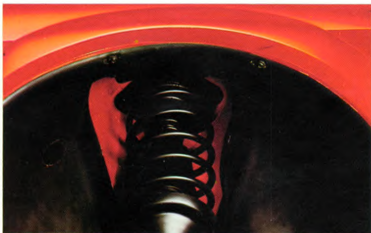
De Scirocco is optimaal tegen roest beschermd. Naast meerdere laklagen, met was geconserveerde holle ruimten en een bescherm laag op de bodem, zijn kunststof steenslagbeschermers aangebracht in de voorste wielkasten.
