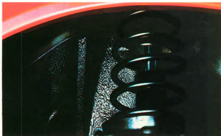
Hier ziet u de veerpoot van de voorwielophanging. In combinatie met de gekoppelde wielgeleiders van de achteras goed voor een perfect weggedrag.
