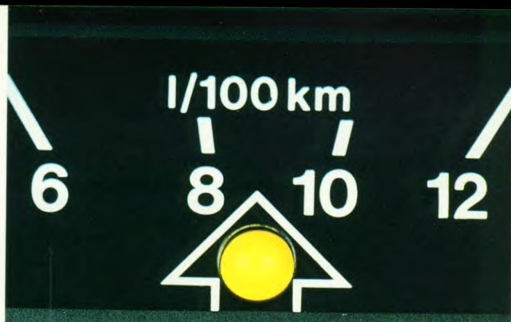
De schakelindicator geeft aan wanneer u moet opschakelen om het meest gunstige brandstofverbruik te realiseren. De verbruiksmeter laat u – in de hoogste versnelling – zien, hoeveel u bij een bepaalde snelheid verbruikt (niet bij automatische transmissie).
