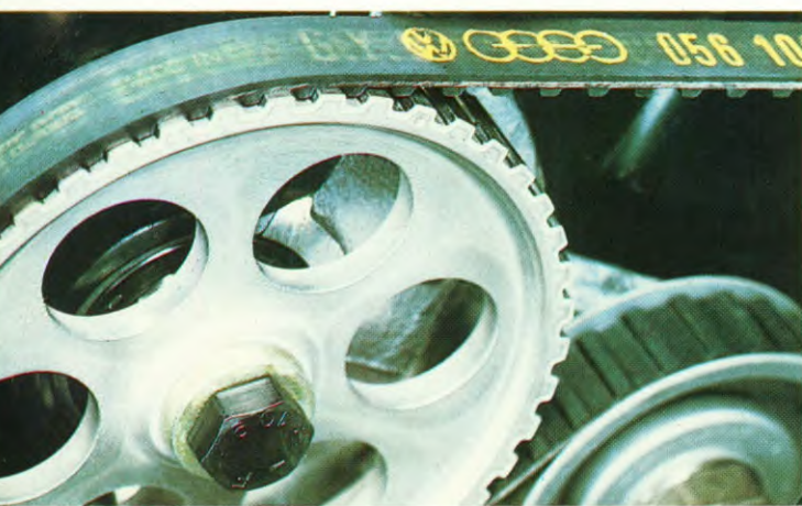
Een van de bewijzen voor het feit dat de Santana motoren tot de modernste ter wereld behoren, is de geruisloze tandriem die de nokkenas aandrijft.
