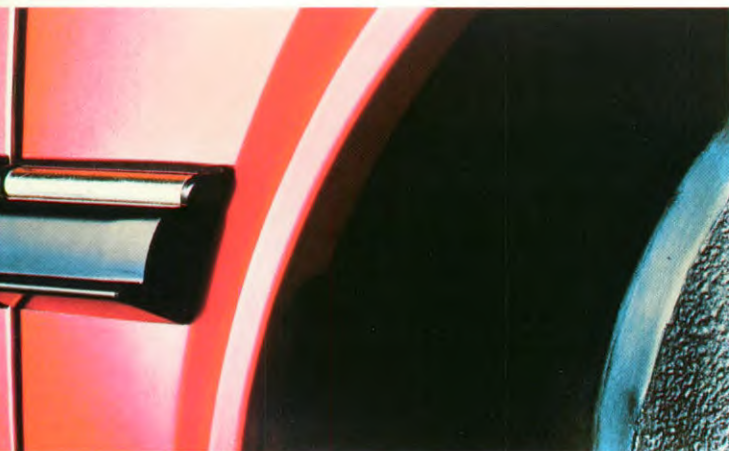
Optimaal beschermd tegen roest en steenslag. Naast een meervoudige laklaag, met was geconserveerde holle ruimten en een beschermklaag op de bodem, zijn in de voorste wielkasten kunststof steenslagbeschermers gemonteerd.
