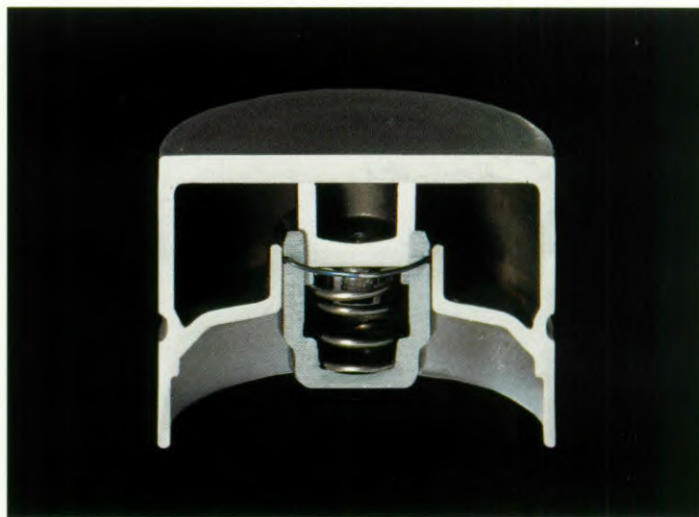
De hydraulische klepstoters. Deze klepstoters zijn onderhoudsvrij: er hoeven nooit kleppen te worden gesteld. Daarbij waarborgen zij bij iedere omwenteling van de nokkenas de juiste klepspel met alle voordelen van dien.
