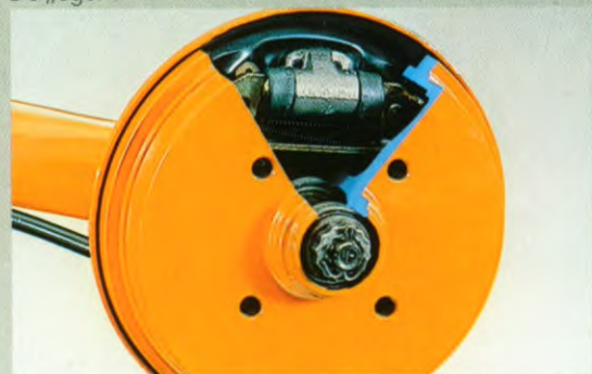
De zelfsstellende trommelrem.
