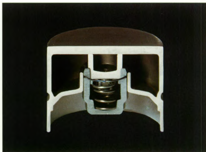
De hydraulische klepstoters. Deze klepstoters zijn onderhoudsvrij; er hoeven dus nooit kleppen gesteld te worden. Zij zorgen bij iedere nokkenasomwenteling voor de juiste klepspel, met alle voordelen van dien.
