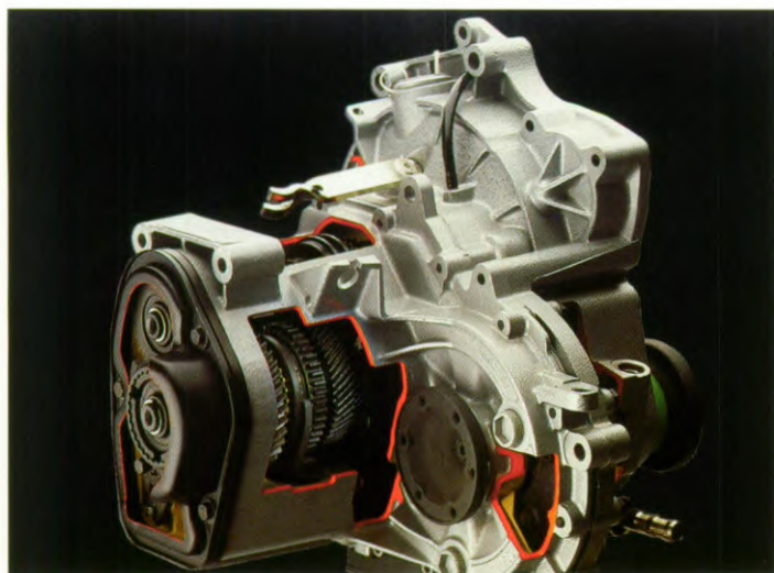
De 5-versnellingsbak. In de vijfde versnelling kan men bij een gegeven snelheid lager in toeren rijden dan in de vierde versnelling. Dat veroorzaakt minder lawaai, minder slijtage en een lager brandstofverbruik. Bovendien zijn de aandrijfassen uitgerust met conische rollagers, die sterker zijn en een langere levensduur hebben.
