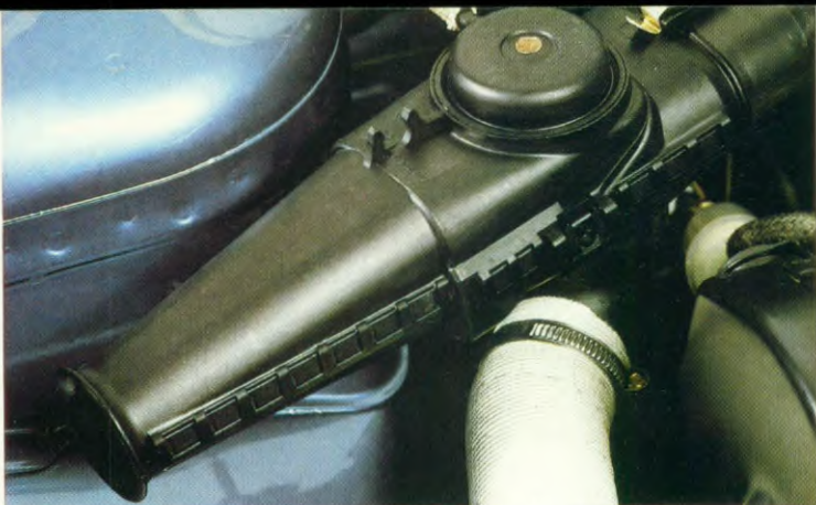
Afhankelijk van de temperatuur van de buitenlucht, regelt een thermostaat de temperatuur van de inlaatlucht.
