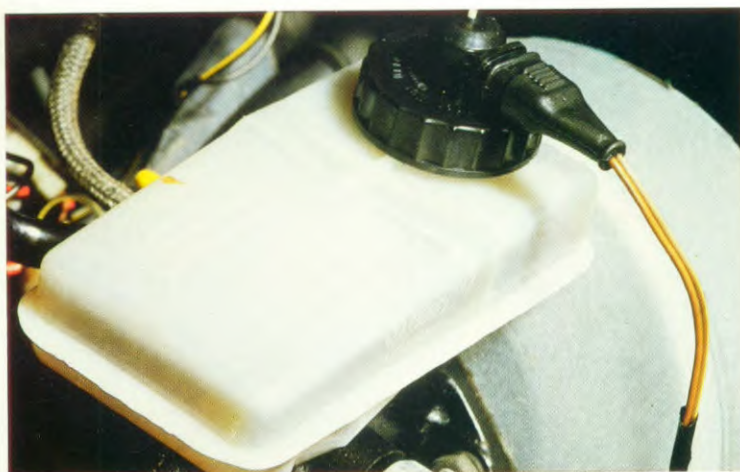
Om er zeker van te zijn dat er voldoende remvloeistof voorhanden is, heeft het remvloeistofreservoir een niveauverklapper met een controlelampje op het dashboard. (Standaard in de Polo CL en GL.)
