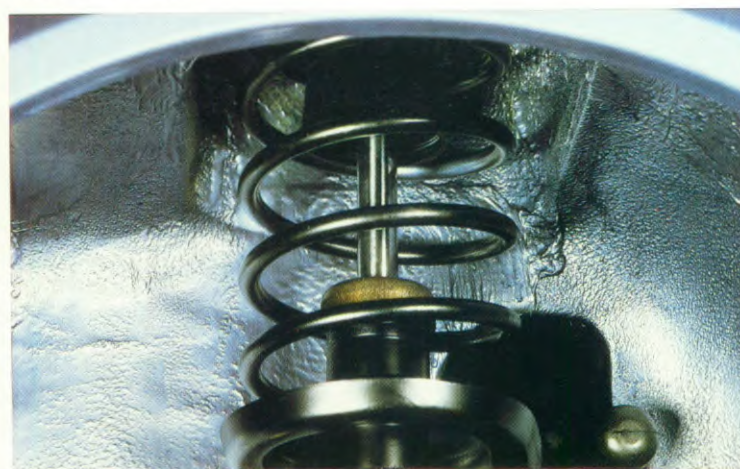
Hier ziet u een veerpoot van de voorwielophanging. In combinatie met de gekoppelde wielgeleidingsarmen van de achteras goed voor een perfect weggedrag.
