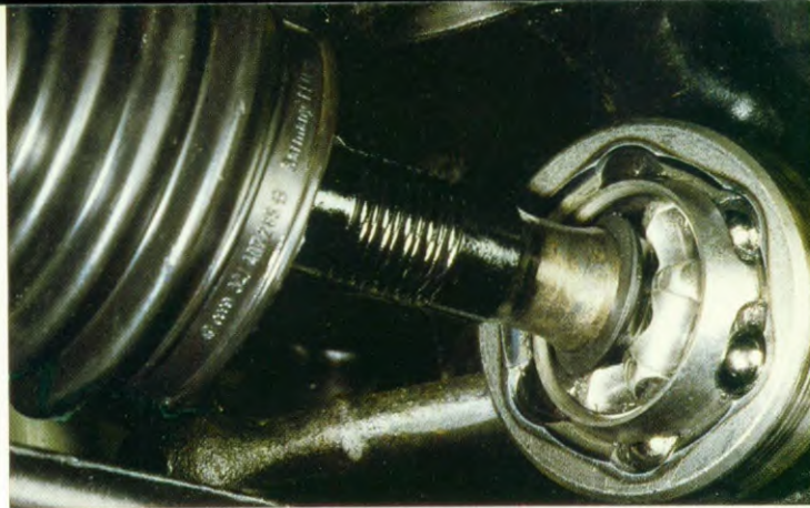
De aandrijfassen hebben robuuste homokinetische koppelingen, die iedere beweging van de aandrijfassen volgen. Ze worden bovendien optimaal beschermd door rubber manchetten.
