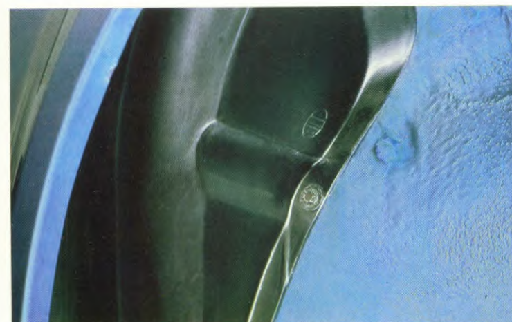
De Polo is optimaal beschermd tegen roest en steenslag. Naast een meervoudige laklaag, met was geconserveerde holle ruimten en een robuuste bescherm laag aan de onderzijde, heeft de Polo ook nog kunststof steenslagbeschermers in de voorste wielkasten.
