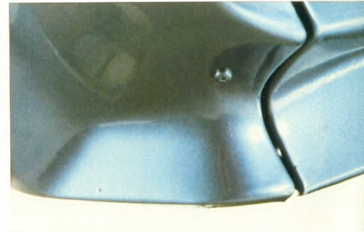
De voorspoiler zit er niet voor niets. Deze vermindert de luchtweerstand en daarmee het brandstofverbruik en verbetert de wegligging bij hoge snelheden.
