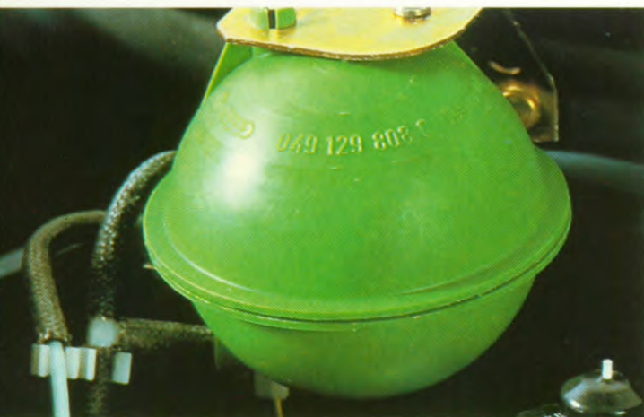
Opdat ook de koude motor van begin af aan rond loopt, wordt het ontstekings-tijdstip automatisch ingesteld. Dat gebeurt bij de 1.05 l motor onder andere met behulp van deze onderdrukdoos.
