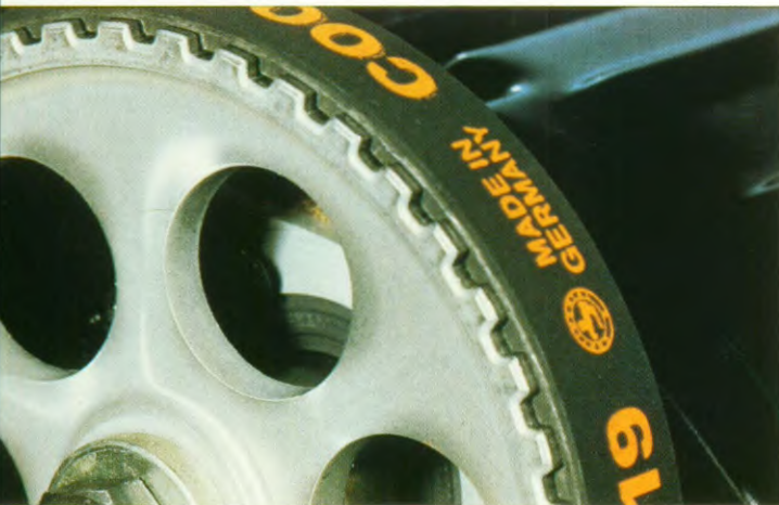
De motoren van de Polo Classic behoren tot de modernste die er zijn. Terwijl bij veel andere motoren de nokkenas nog steeds door een ketting wordt aangedreven, heeft de Polo Classic al lang een geruisarme tandriem.
