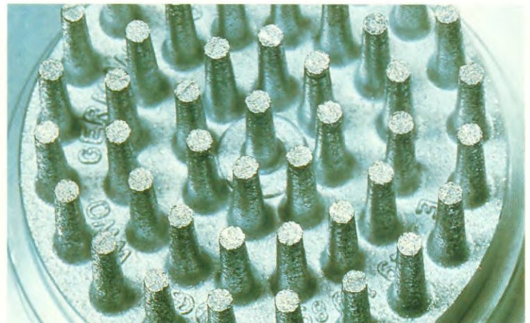
In het aanzuigkanaal van de motor zit deze metalen egel. In de opwarmperiode wordt hij elektrisch verhit en verwarmt zo de aanzuiglucht die langs hem stroomt. Resultaat: De koude motor loopt rond en zuiniger.
