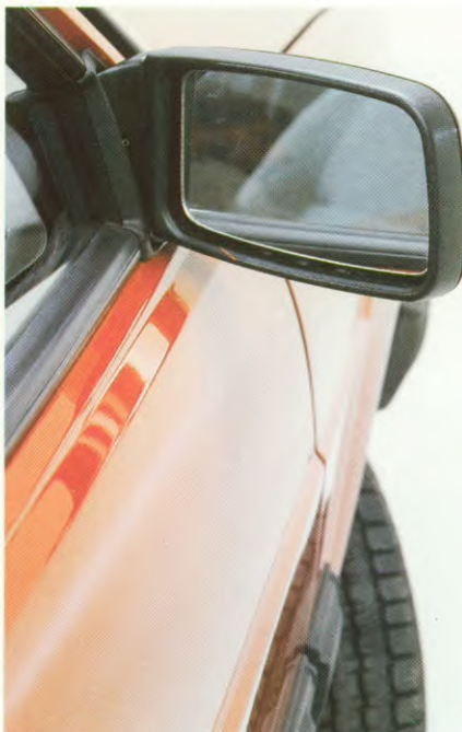
Spiegels springen na aanstoten terug in de oorspronkelijke stand
