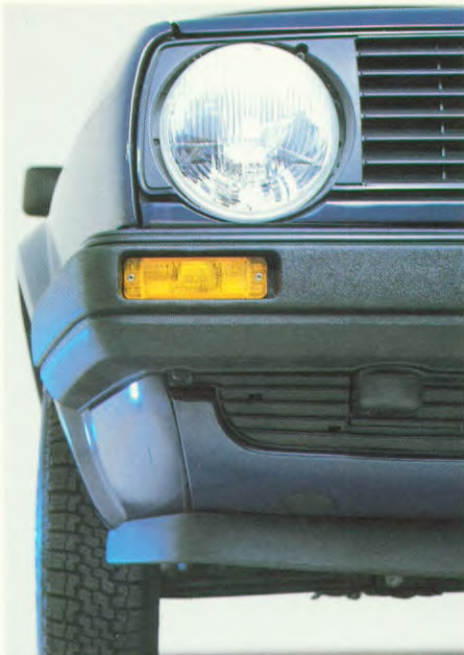
Extra bescherming tegen steenslag met PVC-coating onder de bumper.
