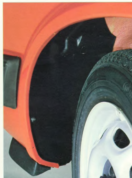
Kunststof beschermkap voorkomt schade aan de steek en kasten door steenslag.
