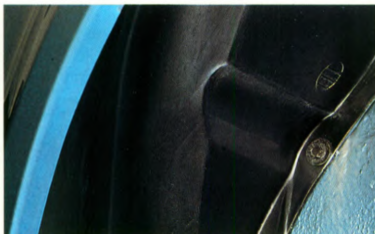
De Polo Coupé is optimaal beschermt tegen roest en steenslag. Naast een meervoudige laklaag, met was geconserveerde holle ruimten en een beschermlaag aan de onderzijde, heeft de Polo Coupé kunststof steenslagbeschermers in de voorste wielkasten.
