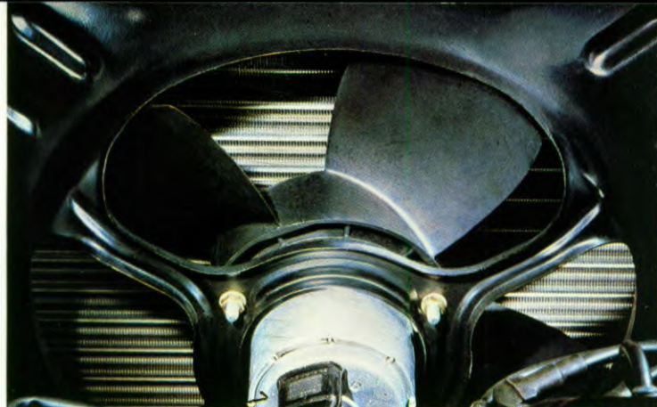
De elektrisch aangedreven koelventilator van de Polo Coupé draait alleen als dat nodig is. Dat spaart brandstof.
