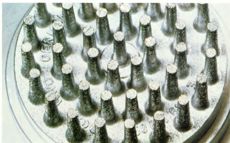
In het luchtinlaatkanaal van de 55 kW (75 pk) motor zit deze metalen „egel”. Tijdens het warmdraaien van de motor verwarmt deze de aangezogen lucht die er langs stroomt. Voordeel: de koude motor loopt beter en zuiniger.
