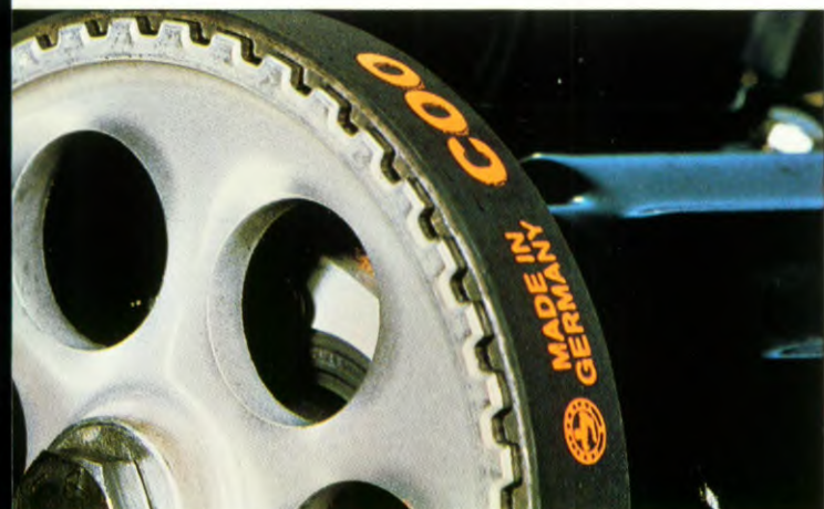
De motoren van de Polo Coupé behoren tot de modernste van dit moment. Wordt bij veel andere motoren de nokkenas aangedreven door een ketting, de Polo Coupé heeft een geruisarme getande riem.
