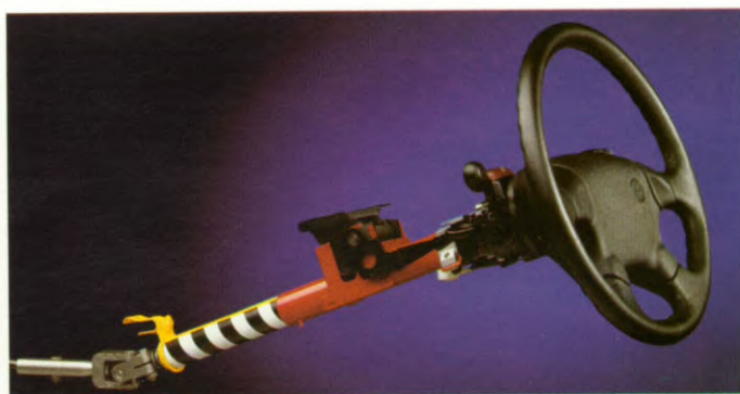
De veiligheidsstuurkolom schuift bij een frontale aanrijding als een telescoop in elkaar. Het gevaar dat het stuurwiel in het interieur binnendringt, wordt daardoor aanzienlijk verkleind.
